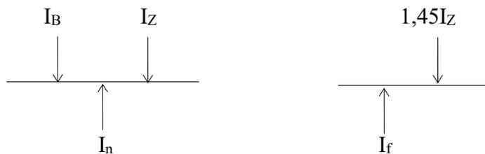
dove:  $I_B$  = corrente di impiego del circuito;
