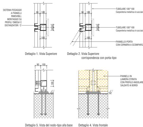
Dettaglio-tipo fissaggio telaio metallico alla fondazione scala 1:20
