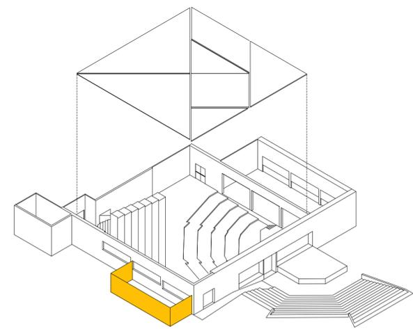
Assonometria esplosa generale del progetto con indicazione della schermatura per gli impianti meccanici
